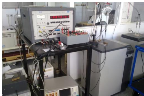
Slika 2. Direktna metoda merenja na temperaturi fiksnih tačaka koristeći nacionalne etalone u DMDM
